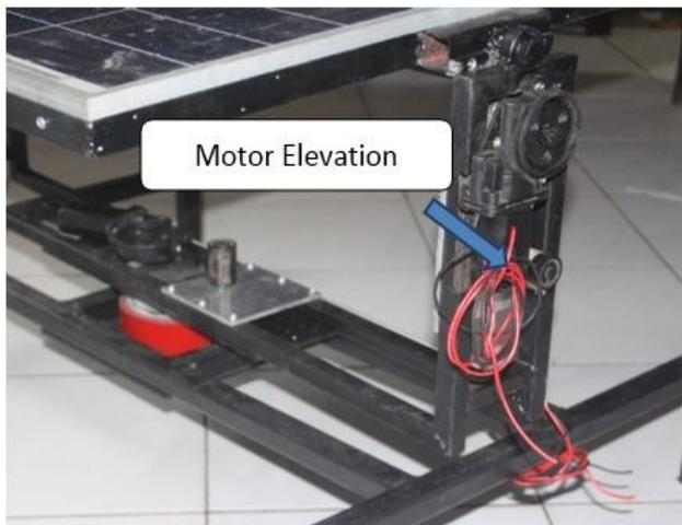
Fig. 7. Motor elevation
