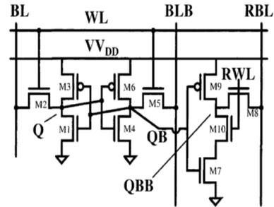
Fig.4. 10T SRAM cell
